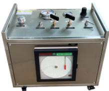
L'enregistreur de pression mesure et enregistre les niveaux de pression au fil du temps, fournissant des données précises pour le suivi des systèmes industriels et hydrauliques.
